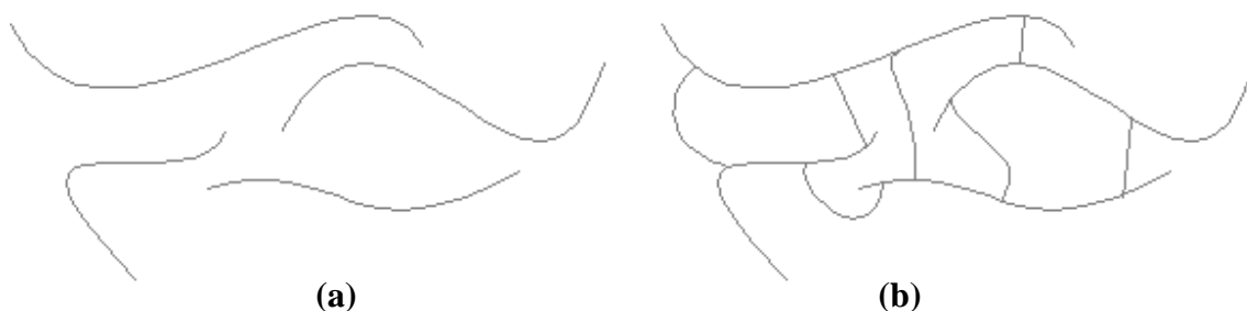
Figura 6. Borracha: (a) não vulcanizada; (b) vulcanizada.
