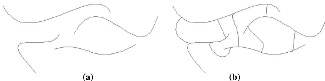
Figura 6. Borracha: (a) não vulcanizada; (b) vulcanizada.
