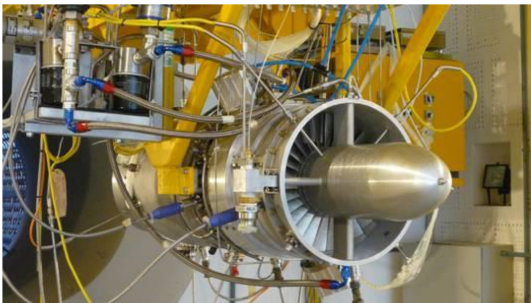
Figura 1 – TR-5000, Turborreator de 5000N, projetado pelo IAE em parceria com a AEROCONCEPTS em testes no Laboratório de Ensaios de Turbinas a Gás.
