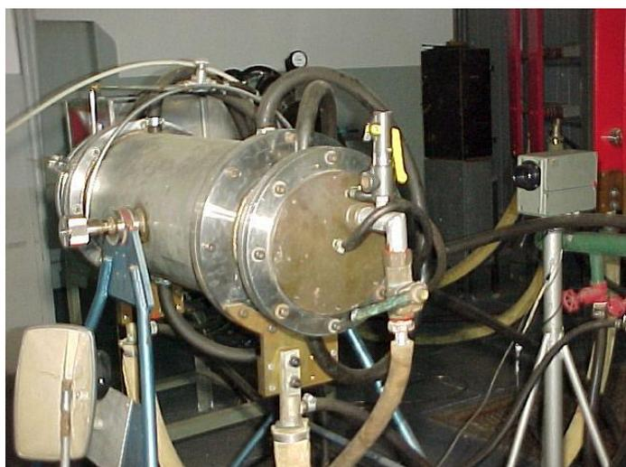
Figura 1- Forno Spembody do LMET utilizado para tratamentos térmicos em aços e ligas metálicas
