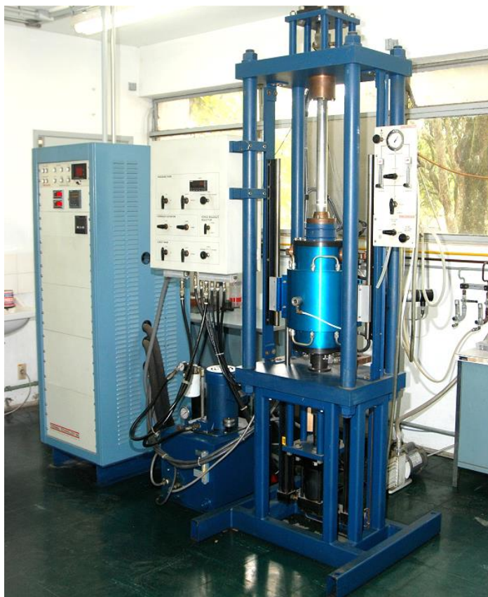
Figura 1- Prensa a quente (20MPa) utilizada para prensagem de amostras.
