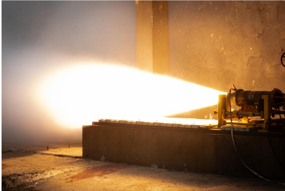
Figura 2 – Ensaio de queima em ponto fixo de um motor foguete
