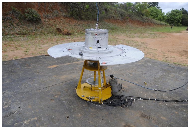
Figura 1 – Configuração de Ensaio Funcional de Subsistema para Veículo de Sondagem
