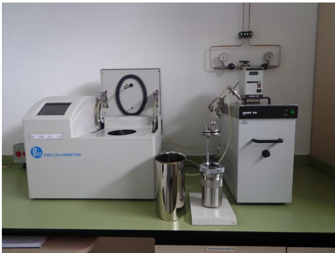
Figura 1: Calorímetro Parr 6200 com banho de circulação e refrigeração e bomba de combustão 1108CL
