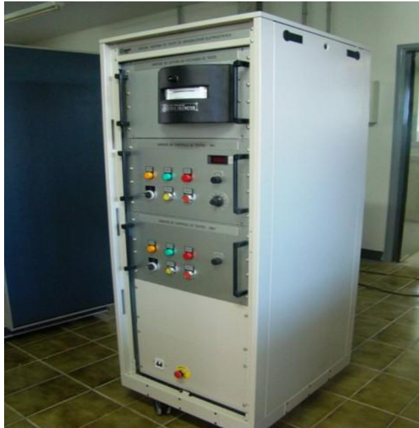
Figura 3: Equipamento ESD-100 Sistema de Teste de Sensibilidade Eletrostática.
