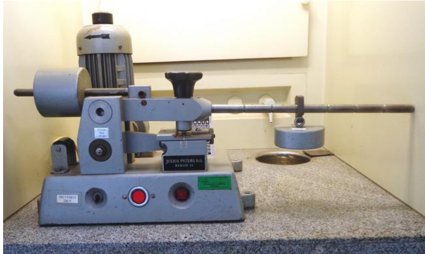
Figura 1: Aparelho BAM de sensibilidade ao atrito
