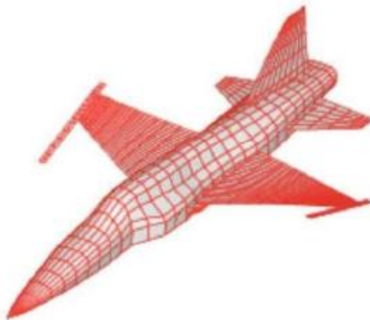
Figura 4 – Malha adaptada para a simulação do modelo aerodinâmico para uma aeronave.
