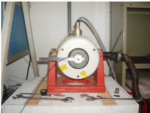
Fig.1 - Viga presa ao “shaker”
