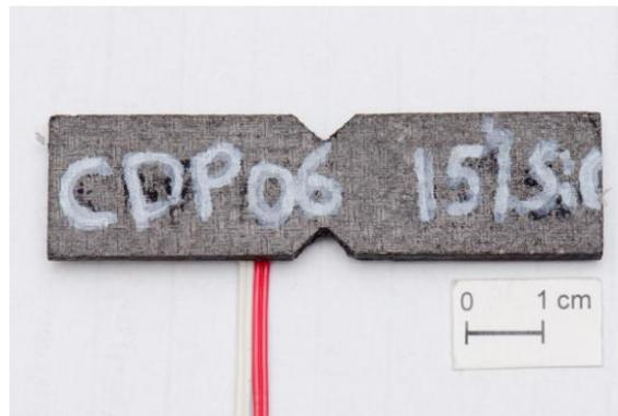
Figura 6 – Imagem do corpo de prova CRFC-15%SiC instrumentado com extensômetro.
