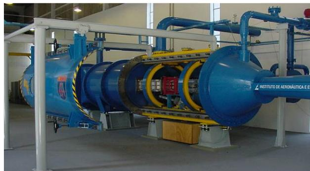
Figura 7. Detalhes da câmara plena do TTP.
