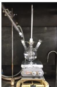
Figura 1-Sistema reacional utilizado na síntese do PECH-PB-PECH.
