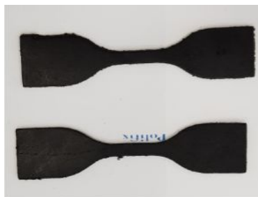
Figura 4 - Cdp's para Ensaio de Tração
