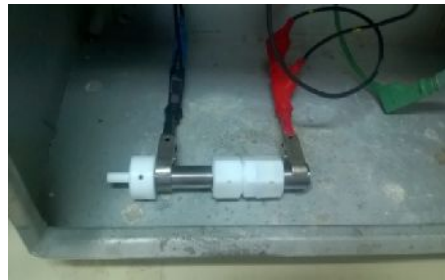
Figura 2 – célula do tipo Swagelok® utilizada nas medidas eletroquímicas, conectada ao potenciostato.
