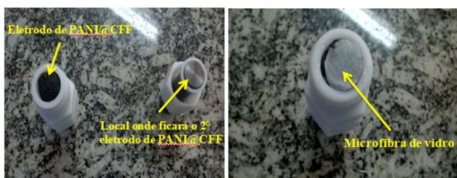
Figura 1 - Célula Swagelok® utilizada para medidas eletroquímicas.
