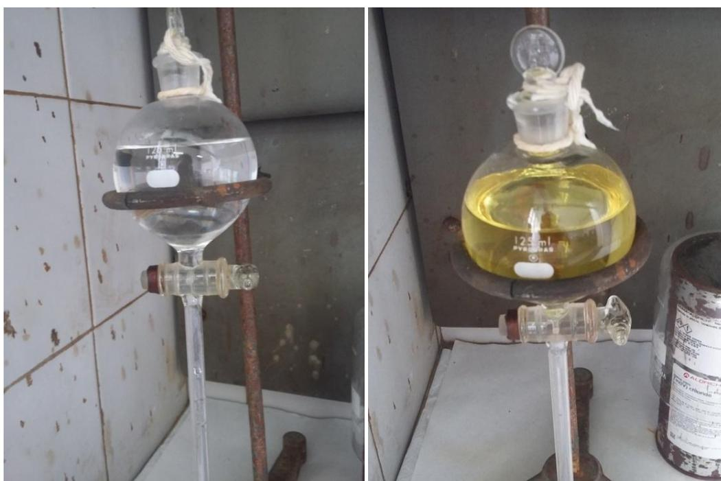
**Figura 2 – Solução de fenol e formaldeído no primeiro dia e após seis dias de reação**
