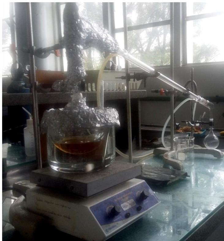
**Figura 3 – Aparelhagem utilizada para a destilação e separação do éter.**
