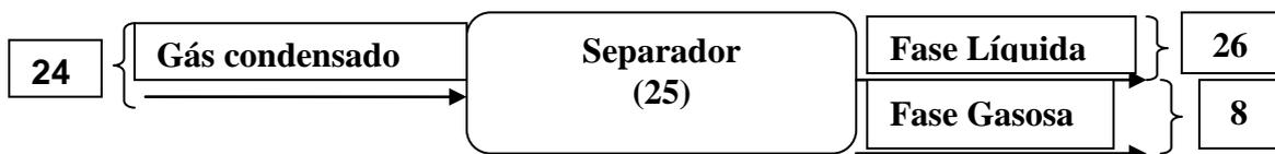
A fase líquida (26) é novamente enviada para a coluna de absorção (13). Enquanto que a fase gasosa (8) será reciclada junto da corrente (6).
