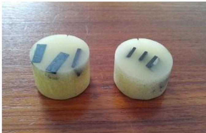
Figura 4 - Preparação dos corpos de prova para microscopia óptica
