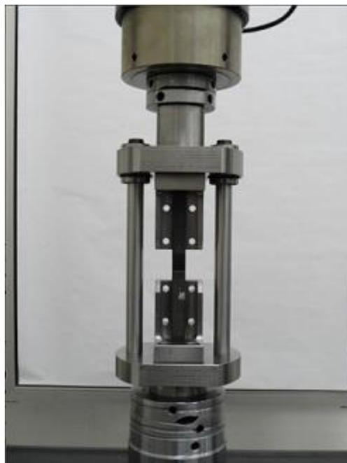
Figura 3 - Dispositivo de ensaios de compressão
