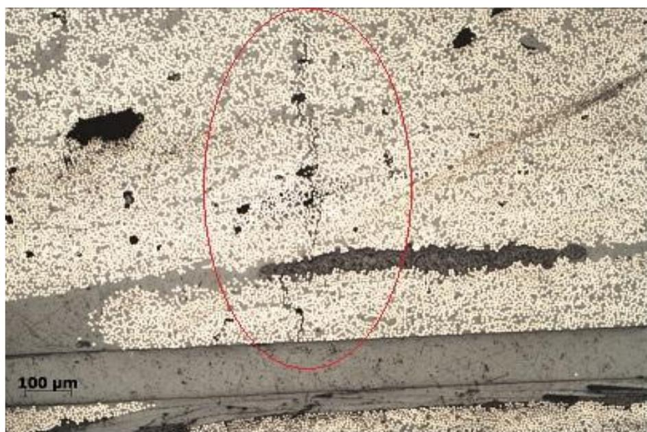
Figura 6 - Compósito com rompimento total, aumento 100x
