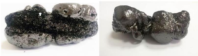
Figura 3. Géis com 30mL de solvente após carbonizados. Sofreram grande expansão.
