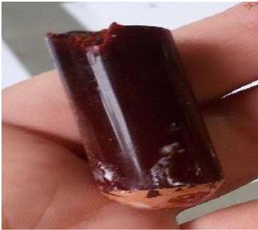
Figura 4. Amostra com 10mL de solvente. Aspecto firme, marron e seco.
