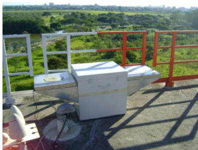
Figura 2 – Antenas de campo elétrico atmosférico de alta taxa de aquisição instaladas nas laterais da caixa (com blindagem metálica - gaiola de Faraday) que contem parte do sistema de aquisição de dados (fontes de alimentação, componentes do link de fibra óptica, etc.)
