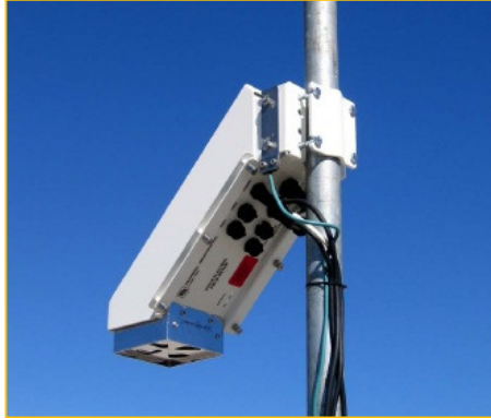
Figura 3 – Antena de campo elétrico de baixa taxa de aquisição
