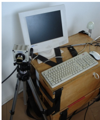
Figura 7 – Câmera rápida com resolução temporal menor que 1ms (taxa de aquisição maior que 1000 quadros por segundo)
