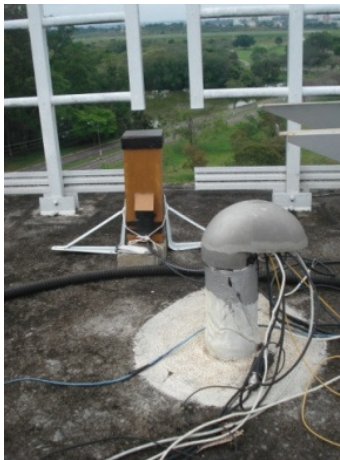
Figura 4 – Caixa contendo cristal e fotomultiplicadora para detecção de radiação X
