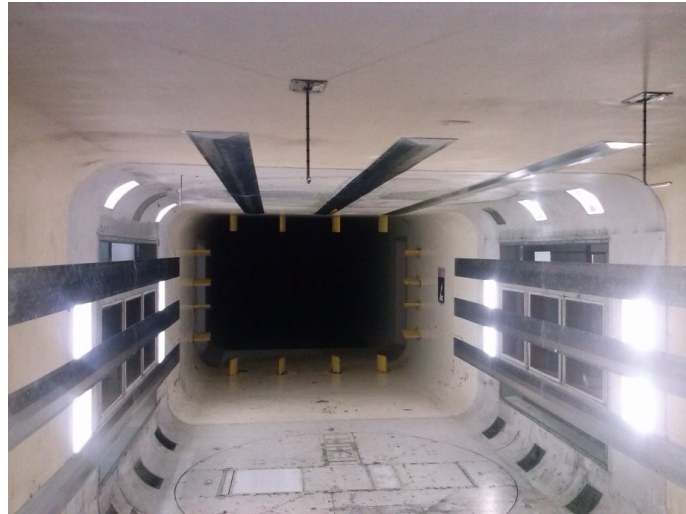
Figura 1: Seção de ensaios do TA-2 com as placas de tomadas de pressão. A montante do escoamento se vê tubos de Pitot.
