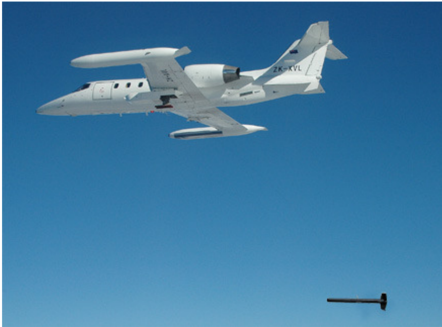
Figura 1 – Exemplo de Sistema Alvo Aéreo sendo estudado neste trabalho. (Fonte: Air Affairs Australia, www.airaffairs.com.au/target_towing.html )
