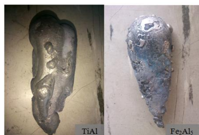
Figura 1: Lingotes dos intermetálicos (Ti-Al e Fe_2Al_5 ) obtidos por fusão à arco.
