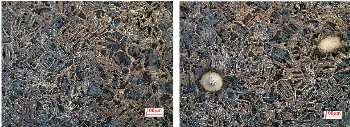
Figura4. Microestrutura da amostra Ti-5Al-5Mo-5V-3Cr sinterizado a 1600°C (LOM).
