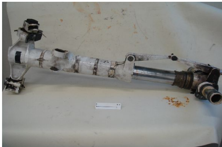
Figura 4- Material recebido (trem de pouso).
