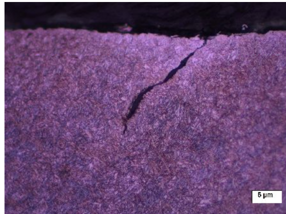
Figura 9 - microestrutura martensítica e trinca secundária.
