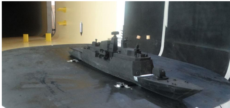
Figura 1 Modelo da Corveta Barroso ensaiado no túnel de vento do IAE
