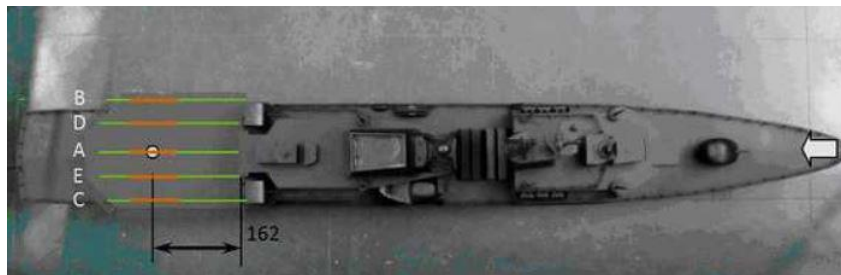
Figura 5 Modelo da Corveta Barroso com o posicionamento dos planos de medição
