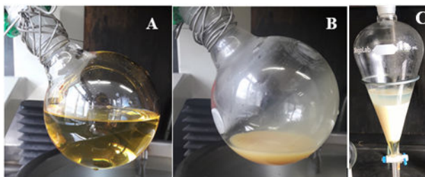
Figura 9: (A) GAP-triol antes da extração do solvente dimetilformamida. (B) GAP-triol após extração do solvente dimetilformamida. (C) Lavagem do GAP-triol.
