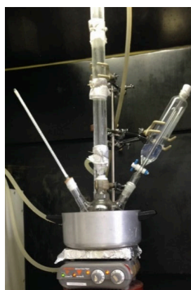
Figura 2: Montagem da vidraria para síntese da PECH-triol.
