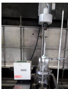
Figura 4: Montagem da vidraria para síntese da PECH-triol.
