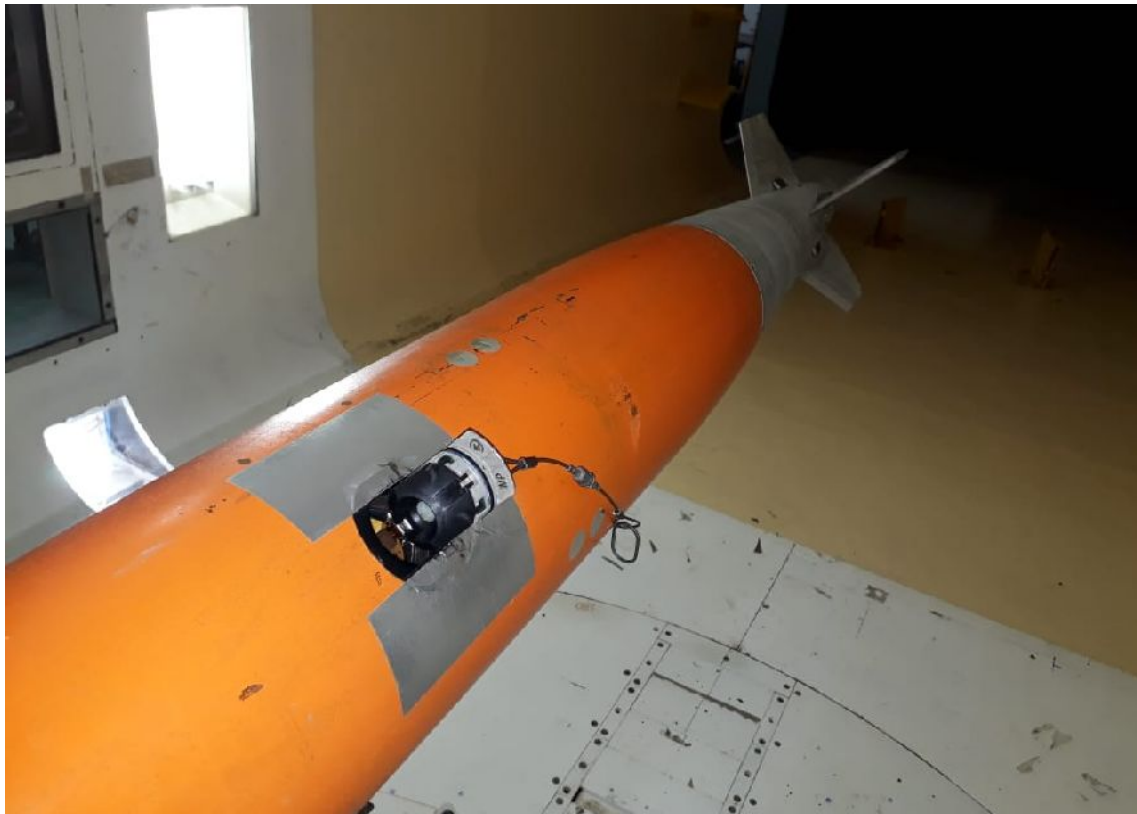
Figura 5. Mockup da BAFG-460, 1:2, com o FZU-48/B.
