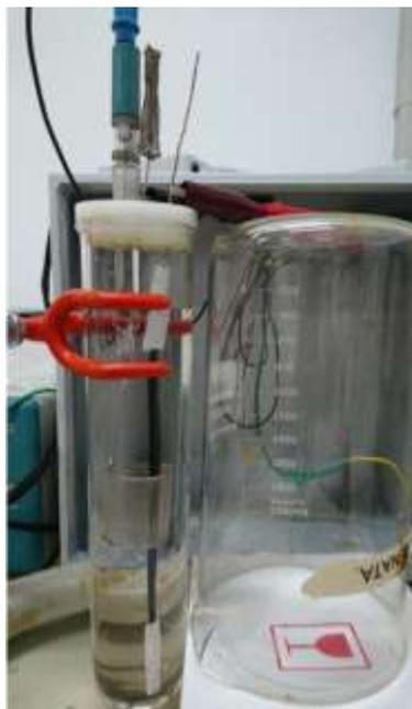
Figura 1. Célula eletroquímica utilizado na eletrossíntese da polianilina no cabo de fibra de carbono.
