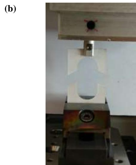
Figura 3. (a) Tribômetro Universal Macro Tester (UMT-2), (b) Amostra fixada na garra e na morsa para o ensaio de tensão.
