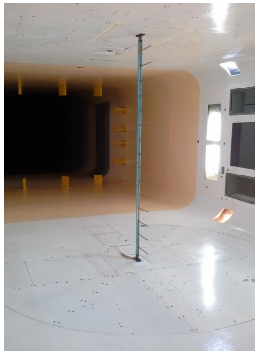
Figura 2. Rake 15 com 15 tubos de Pitot para medição das velocidades na seção de ensaio.
