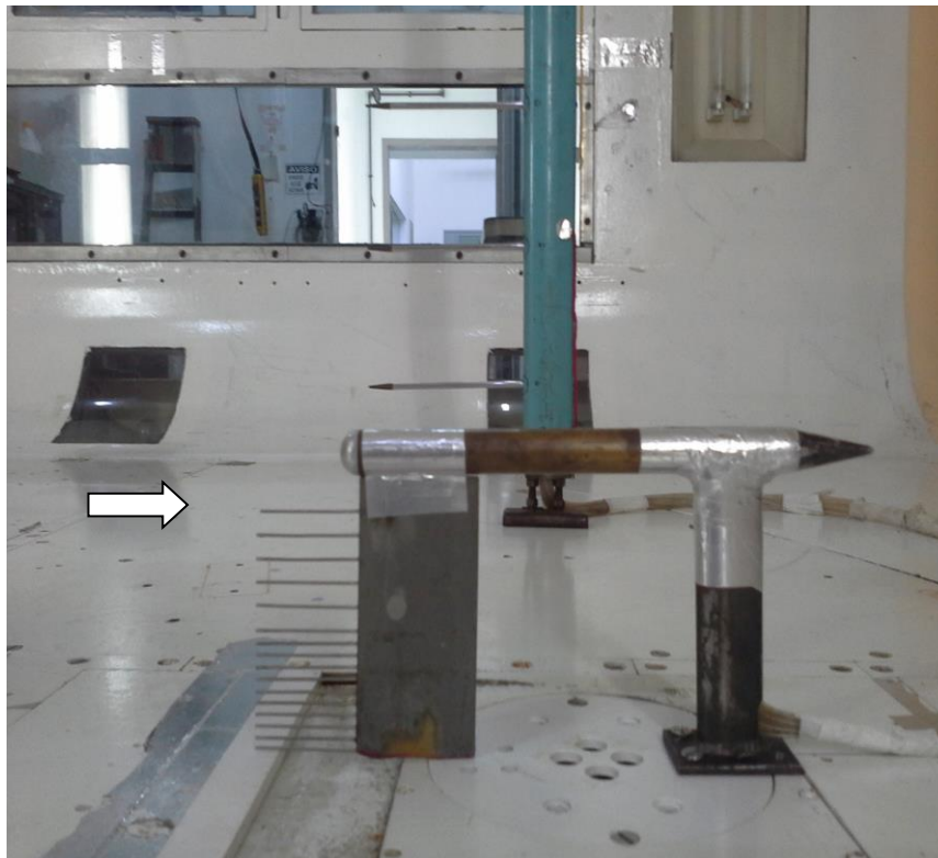
Figura 4. Rake 16 para a medição de camada limite com 16 tubos, posicionado na parede inferior da seção de ensaios do TA-2. A seta indica o sentido do escoamento.
