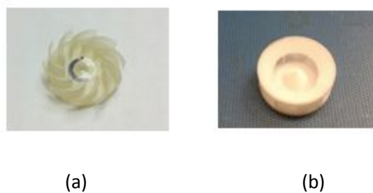
Figura 2 (a) Turbina original em Nylon; (b) Turbina impressa em policarbonato e com alterações de projeto.
