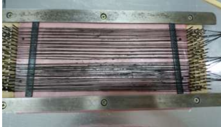
Figura 3. Esquema de preparação dos cabos de fibra de carbono impregnadas com polianilina.
