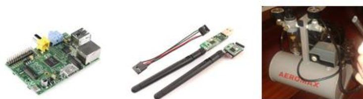
Figura 3. a) Raspberry PI b) Instrumentação wireless 3DR c) Compressor Aeromax.
