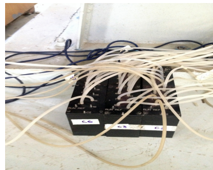
Figura 7: Módulos de leitura de pressão.
