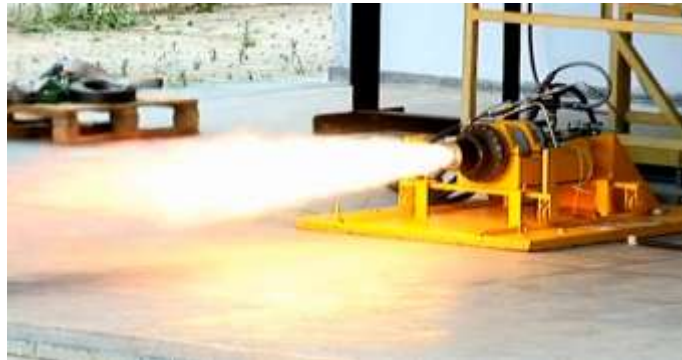
Figura 3 – Motor teste H1 em operação.
