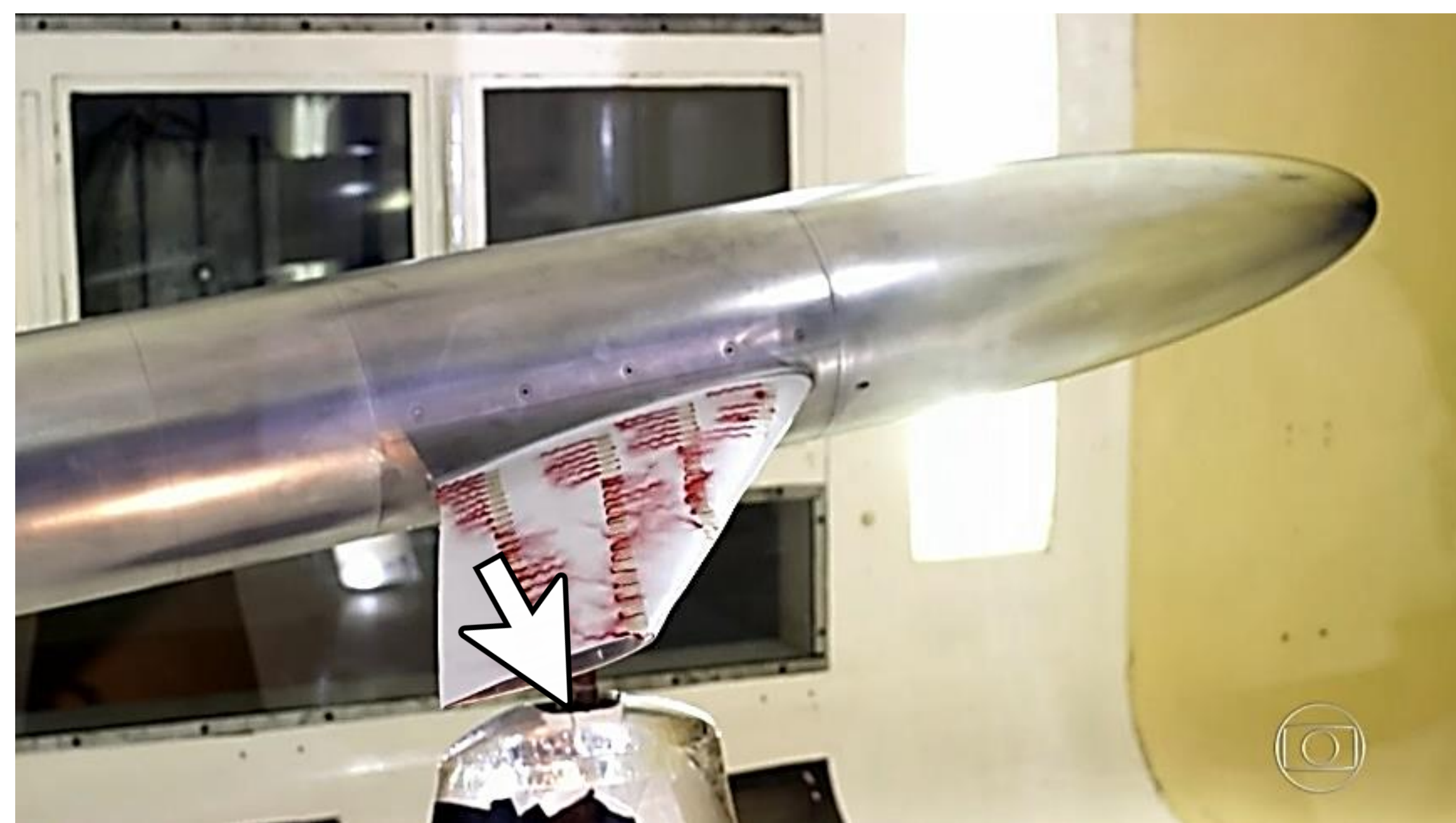
Figura 1 - Visualização de fluxo com tufos de lã do modelo padrão M5/ONERA/IAE no TA-2 com \alpha=8^\circ . Fonte: https://globoplay.globo.com/v/7627502/ .
