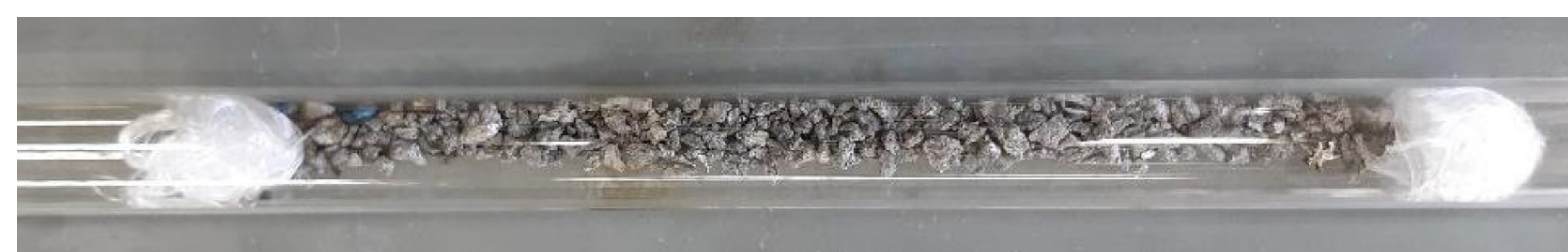
Fig. 4. Esponjas de Ti hidrogenadas à vácuo.
