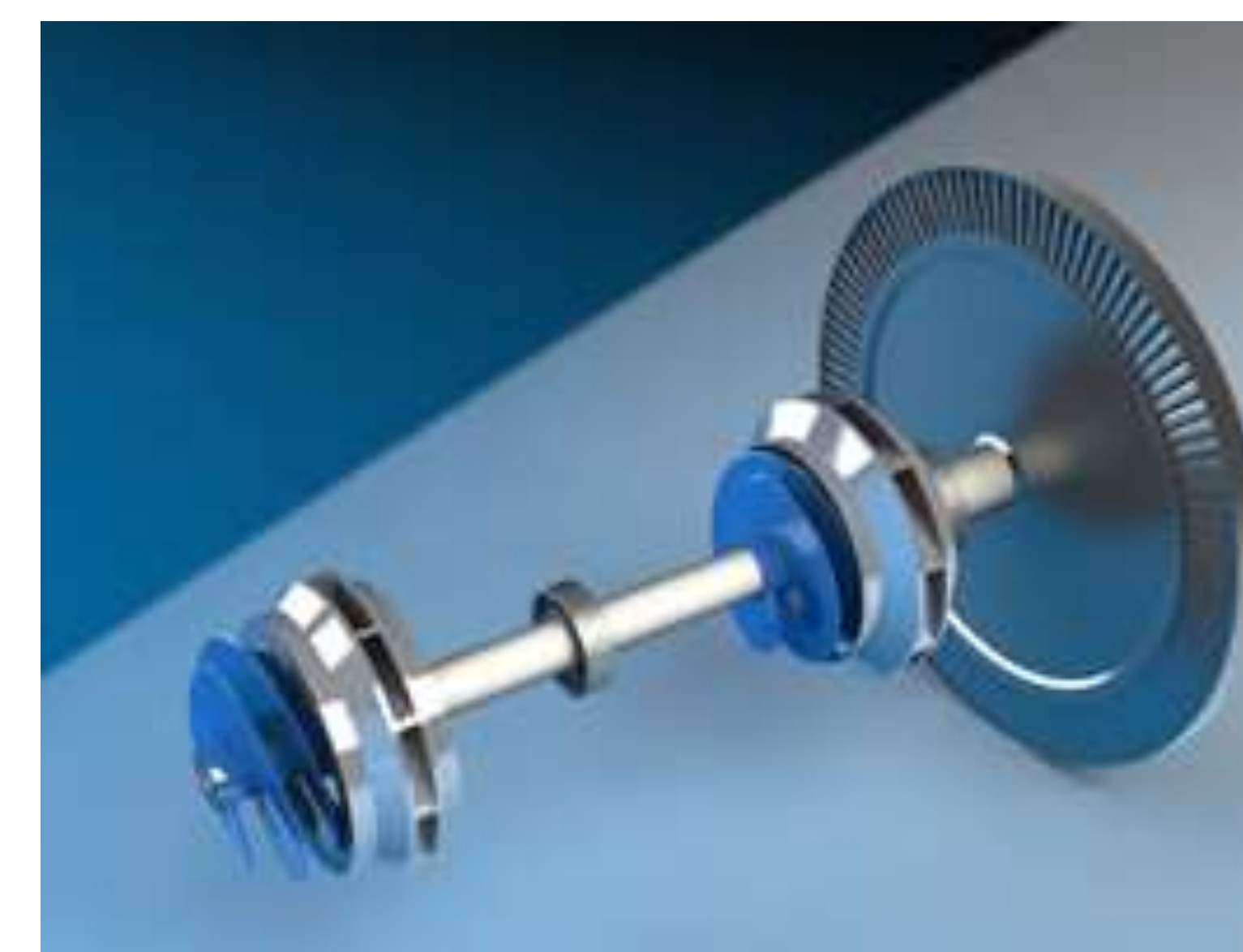
Figura 3: Modelo Computacional do Rotor da Turbobomba (3D studio)
