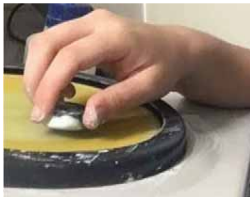
Figura 4- Procedimento de polimento das amostras produzidas por metalurgia do pó.
