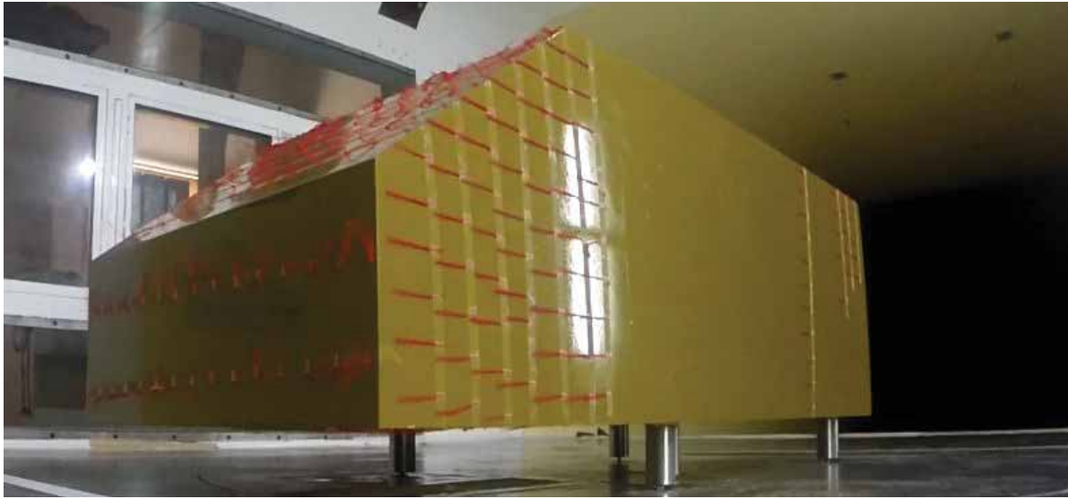
Figura 6. Vista lateral do escoamento no corpo de Ahmed com tufos de lã.
