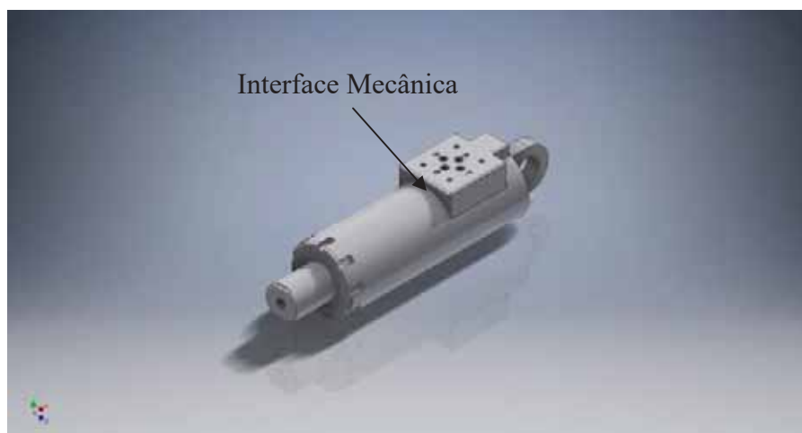
Figura 1 – Corpo do cilindro proposto para o AHN com a Interface Mecânica acoplada.
