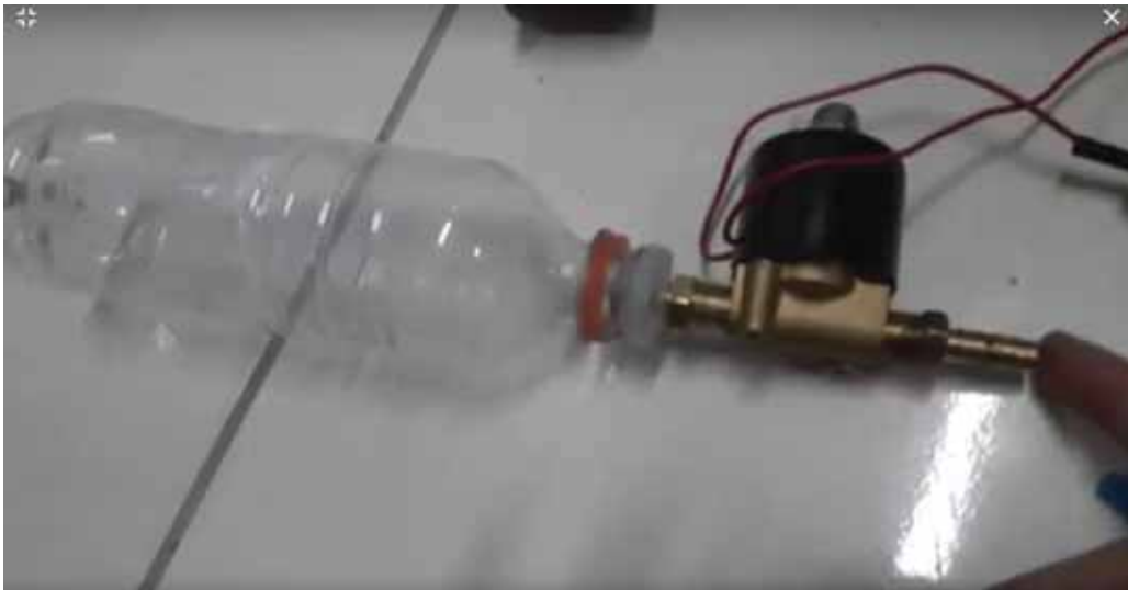
Figura 08 - Montagem de reservatório de ar comprimido com válvula acoplada .
