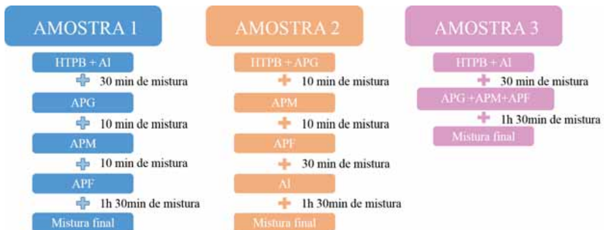
Figura 1 - Representação esquemática dos processos de preparo das amostras ensaiadas.
