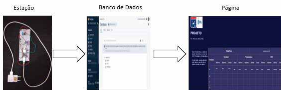
Figura 6: Diagrama de contexto do projeto mostrando a estação meteorológica baseada em Internet das Coisas.
