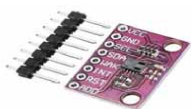
Figura 2: (a) Sensor de CO 2 modelo Ccs-811. (b) Diagrama de conexão entre o sensor Ccs-811 e a plataforma NodeMCU.
