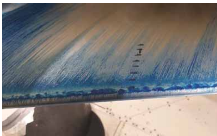
Figura 3.3 - Visualização de fluxo com óleo do modelo padrão M5/ONERA/IAE no TA-2 com \alpha = 4^\circ . Detalhamento dos efeitos da bolha de separação laminar.
