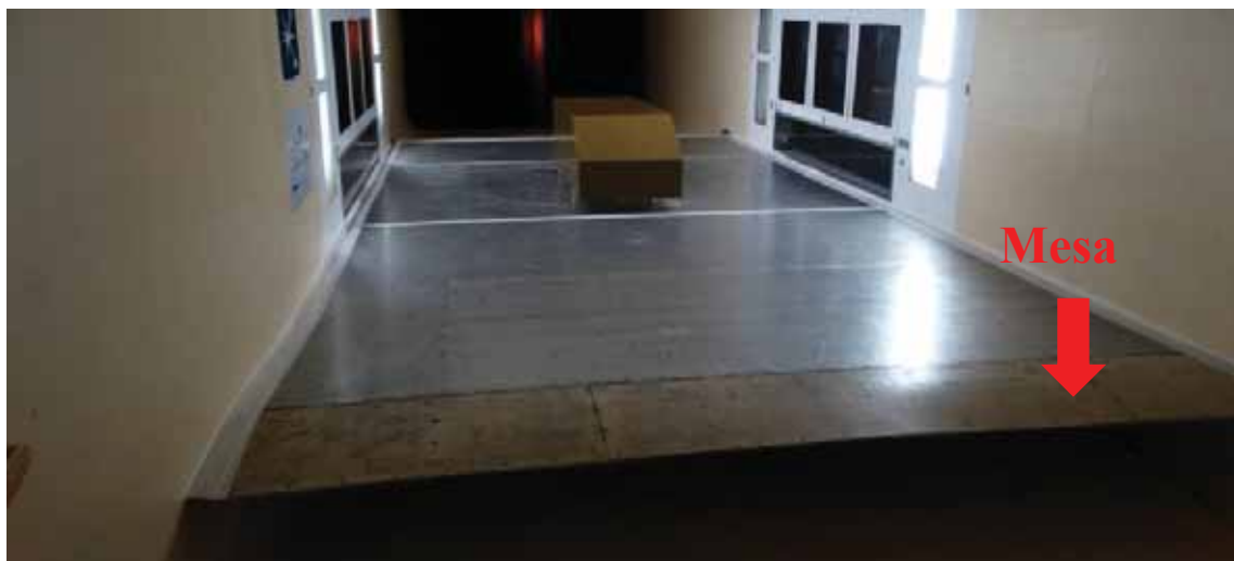
Figura 2. Mesa para redução dos efeitos da camada limite.
