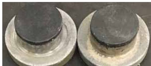
Figura 1. Imagem de um cdp de adesão com suporte metálico (cor cinza) e borracha (cor preta).
