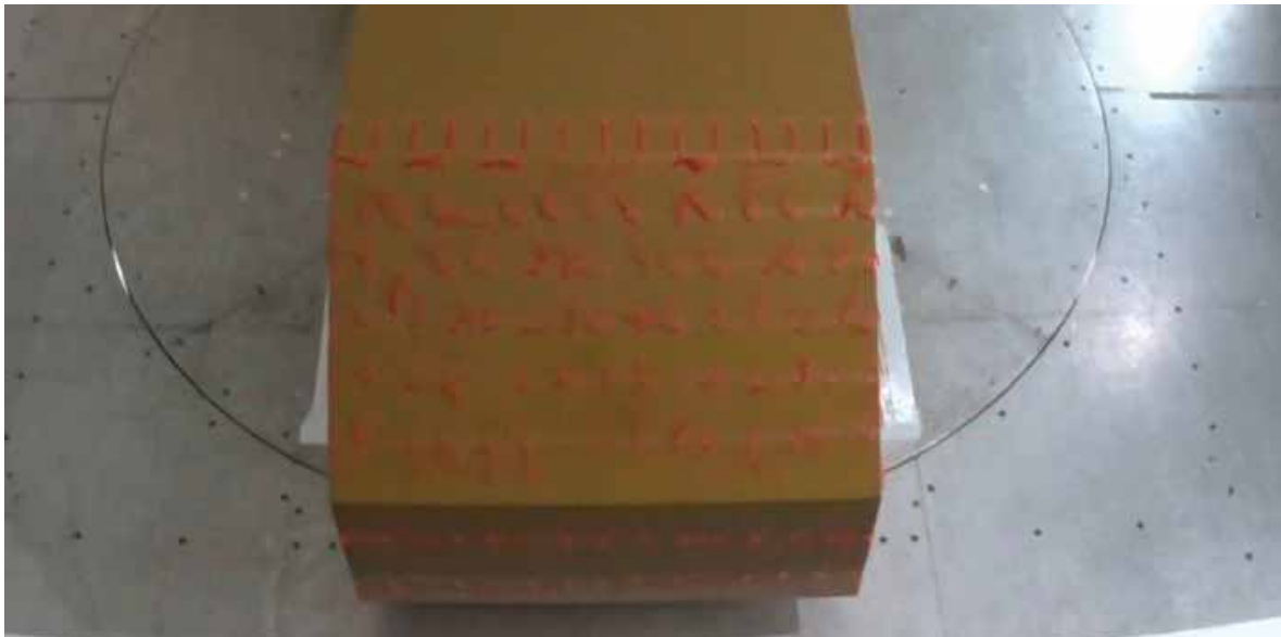
Figura 5. Visualização do escoamento na rampa traseiro utilizando tufos de lã.
