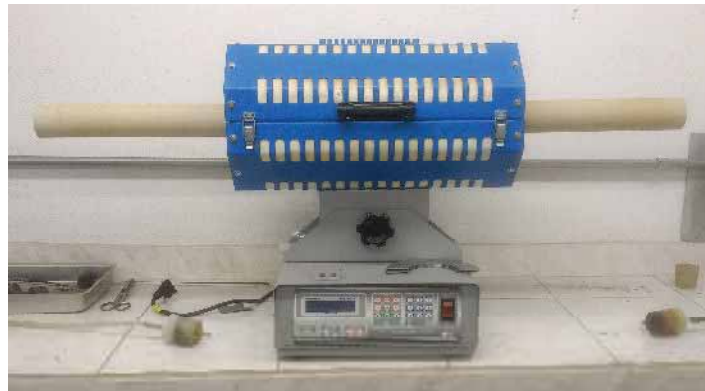
Figura 2 – Forno para sinterização (AMR/IAE)
