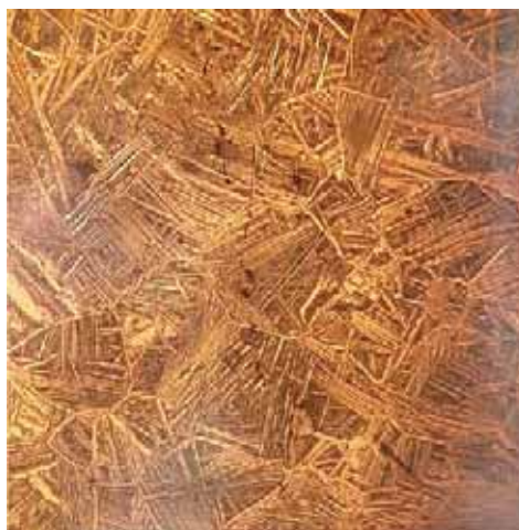
Figura 7- Microestrutura da liga Ti-5Sn sinterizada a 900°C.
