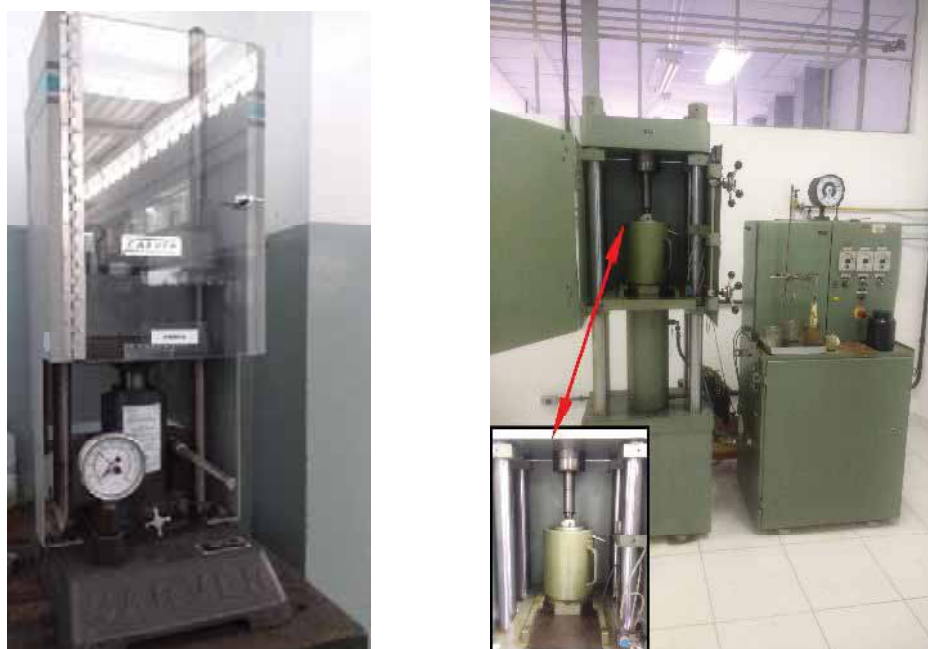
Figura 3 – Prensa uniaxial Carver (AMR/IAE) e prensa isostática Paul Weber KP100E (AMR/IAE) utilizadas na compactação das amostras
