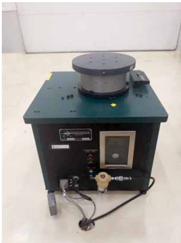
Figura 2. Instrumento de medição de propriedades de massa KSR Space Electronics.
