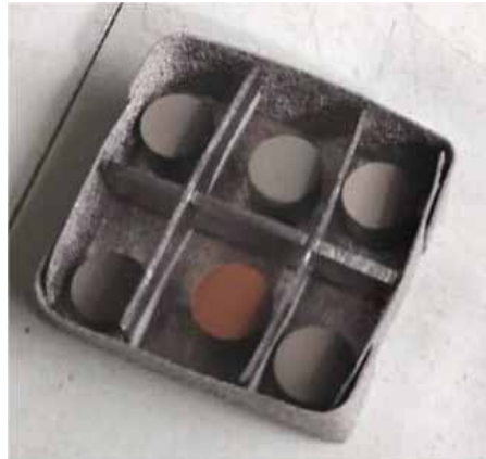
Figura1- Amostras das ligas de titânio após compactação isostática a frio
