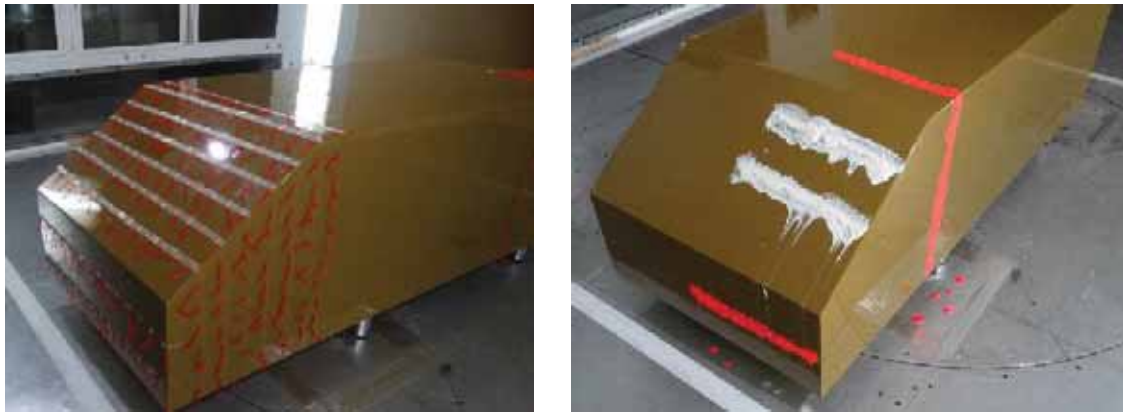
Figura 3. Técnicas de visualização: a) tufos de lã b) óleo.
