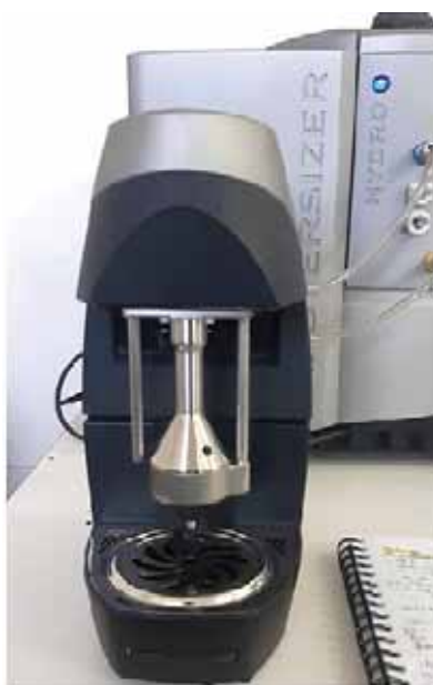
Figura 2- Granulômetro a laser utilizado na determinação do tamanho de partículas.
