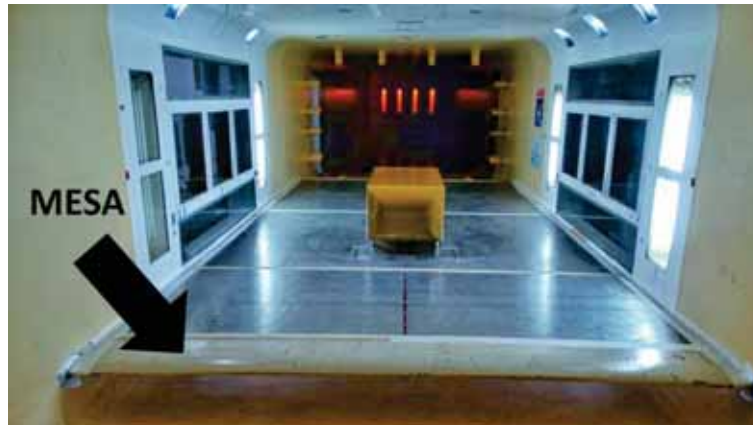
Figura 2: Modelo montado no Túnel de Vento
