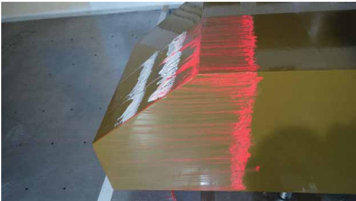
Figura 7. Visualização do escoamento lateral utilizando óleo.
