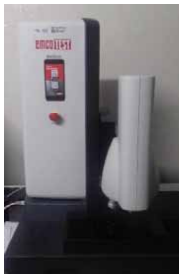
Figura 5 – Microdurometro EMCOTEST dura scan (ITA)
