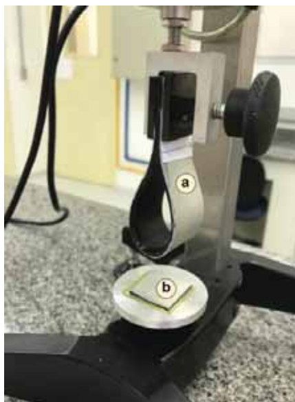
Figura 1 - Preparação para teste de Loop Tack: em (a) tem-se a borracha de NBR dobrada não vulcanizada, com o adesivo a ser testado; em (b) tem-se uma amostra de NBR (sendo esta analisada vulcanizada ou não vulcanizada) com a aplicação do adesivo.
