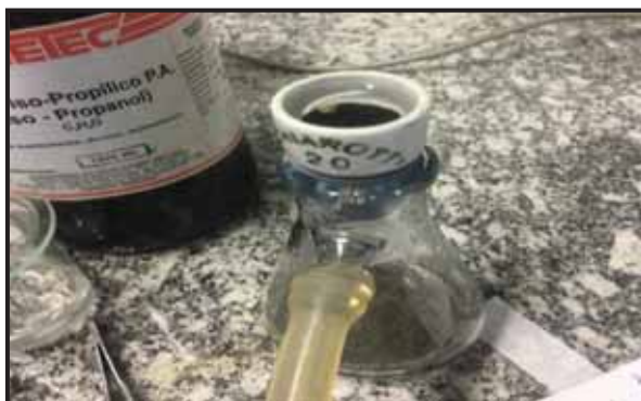
Figura 6 – Filtração a vácuo.
