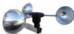
Figura 10: Anemômetro digital que deverá ser incorporado a plataforma futuramente.
