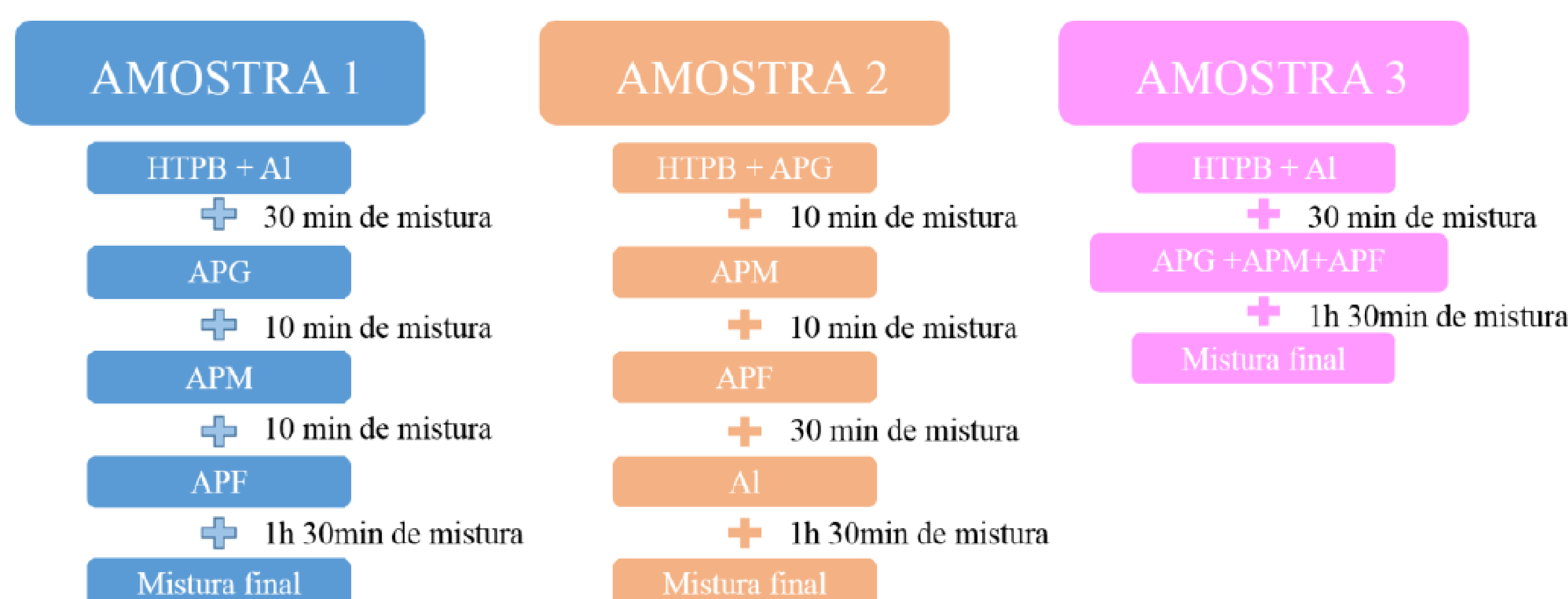
Figura 2 - Representação esquemática dos processos de preparo das amostras ensaiadas.
