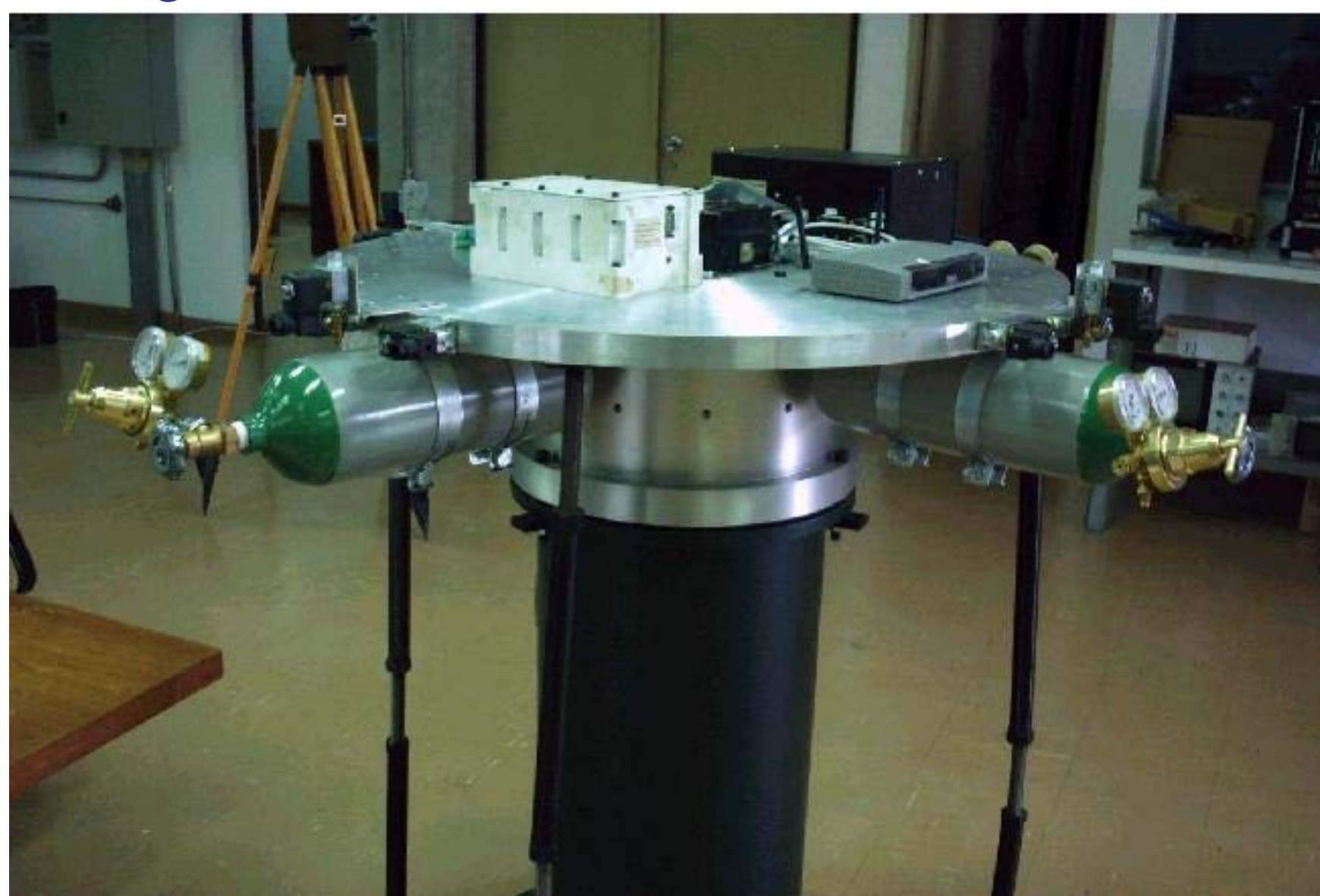
Figura 1 – Plataforma de controle de atitude.
