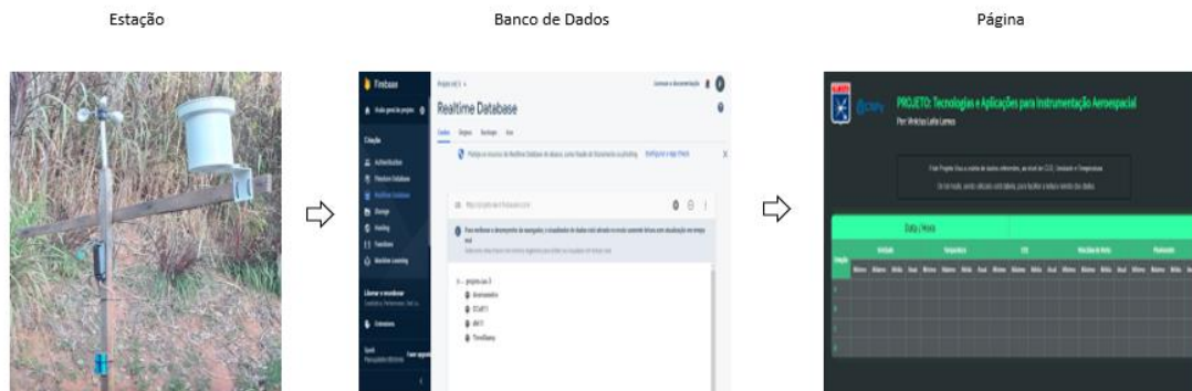
Figura 8: Diagrama de contexto do projeto mostrando a estação meteorológica baseada em Internet das Coisas. Fonte: Autor
