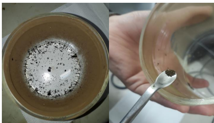
Fig. 2: vaso coletor de amostra sólida contendo material obtido em forma de pó e filme.
