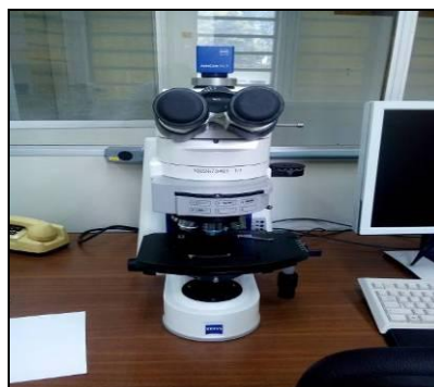
Figura 5 - microscópio Zeiss utilizado para análise microestrutural.
