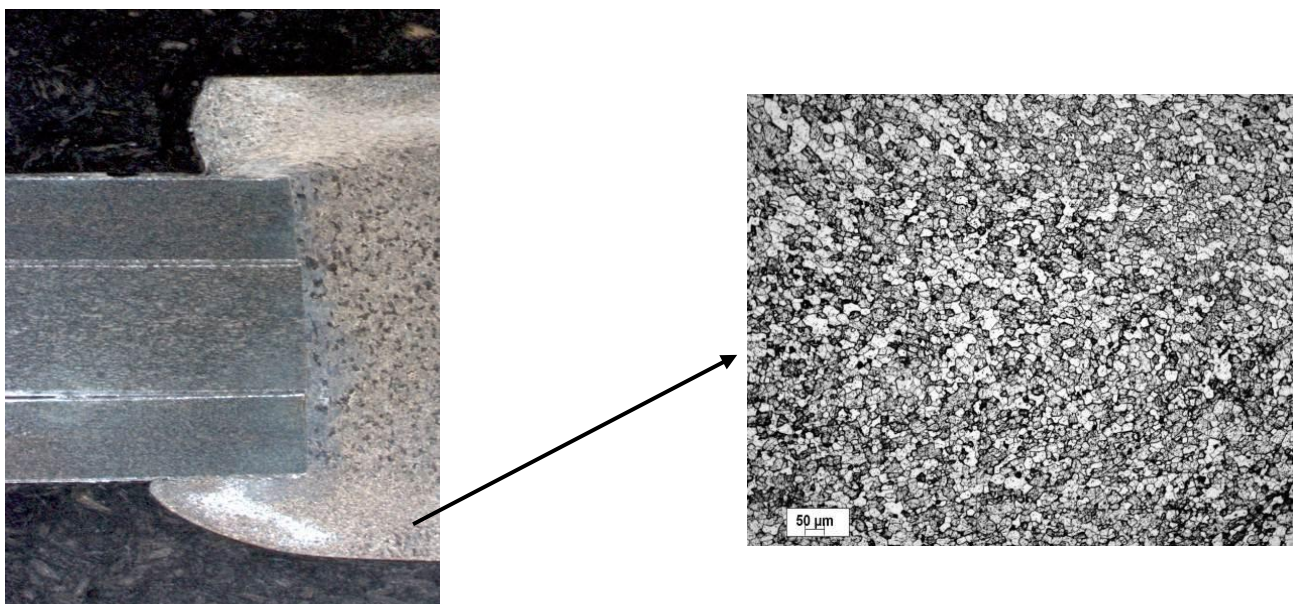
Figura 13 - grãos menores na cabeça do rebite
