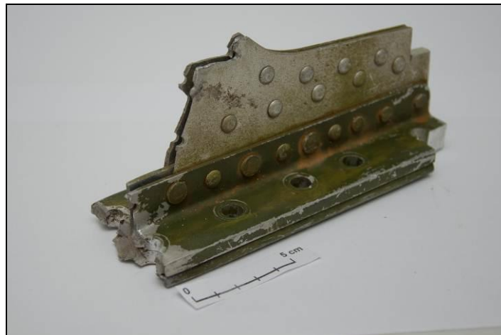
Figura 1 - seção da longarina (material recebido).
