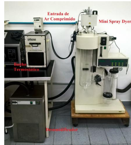
Figura 1 – Equipamento de Spray Cooling
