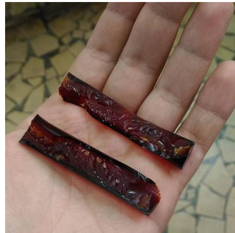
Figura 5: Parte interna do gel logo após ser retirado da estufa. Estrutura interna homogênea.
