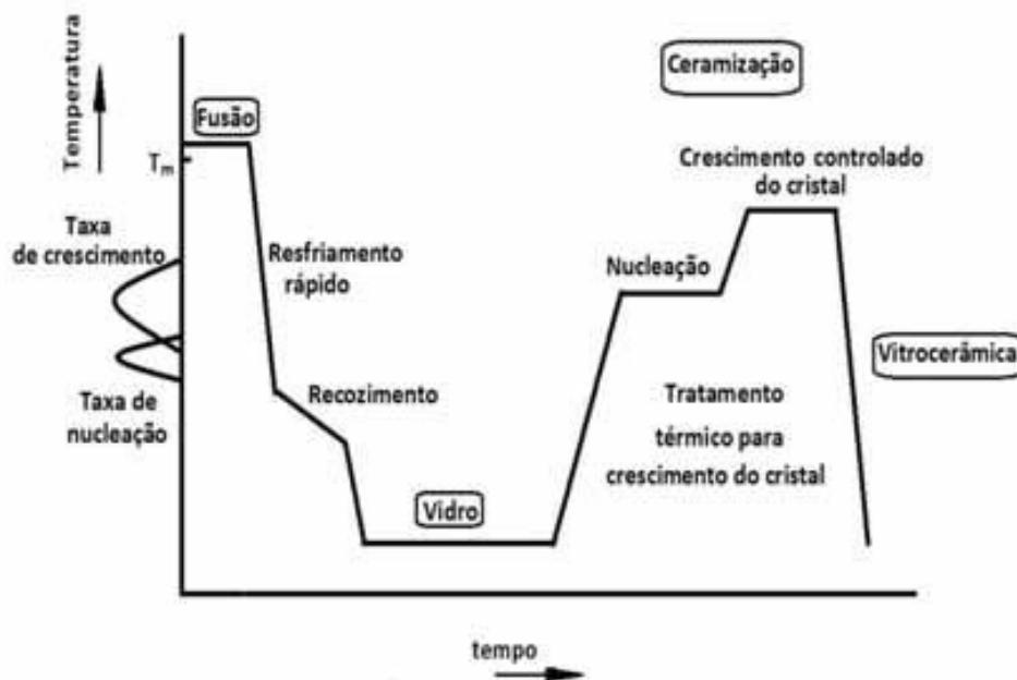
Figura 1 – Processo de obtenção de vitrocerâmico [6].
