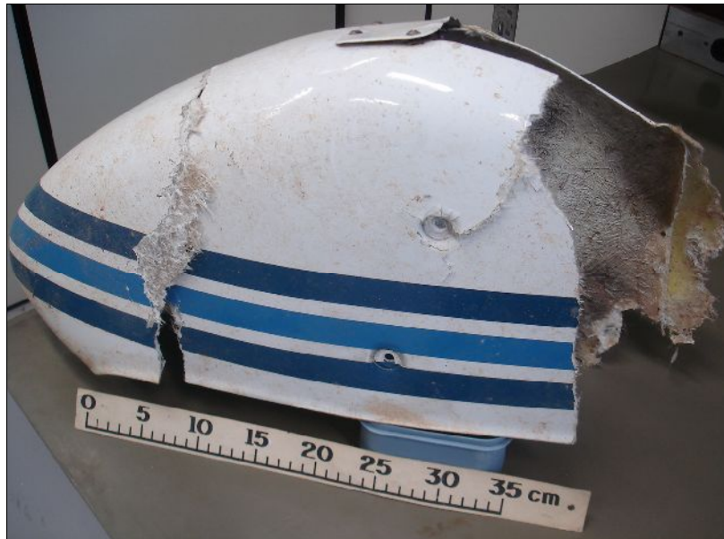
Figura 2-Fotografia. Vista geral da carenagem fraturada por impacto
