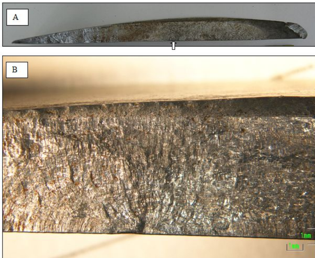
Figura 4-Fotografias. (A) vista geral da superfície de fratura, apresentando uma pré trinca no lado inferior da pá. A seta indica a região de início. (B) detalhe da região de início da trinca, apresentando marcas de praia.
