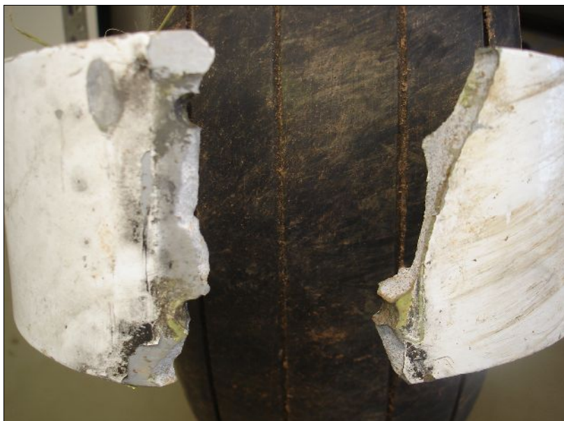
Figura 3-Fotografia. Detalhe da região onde ocorreu a fratura do suporte da roda.
