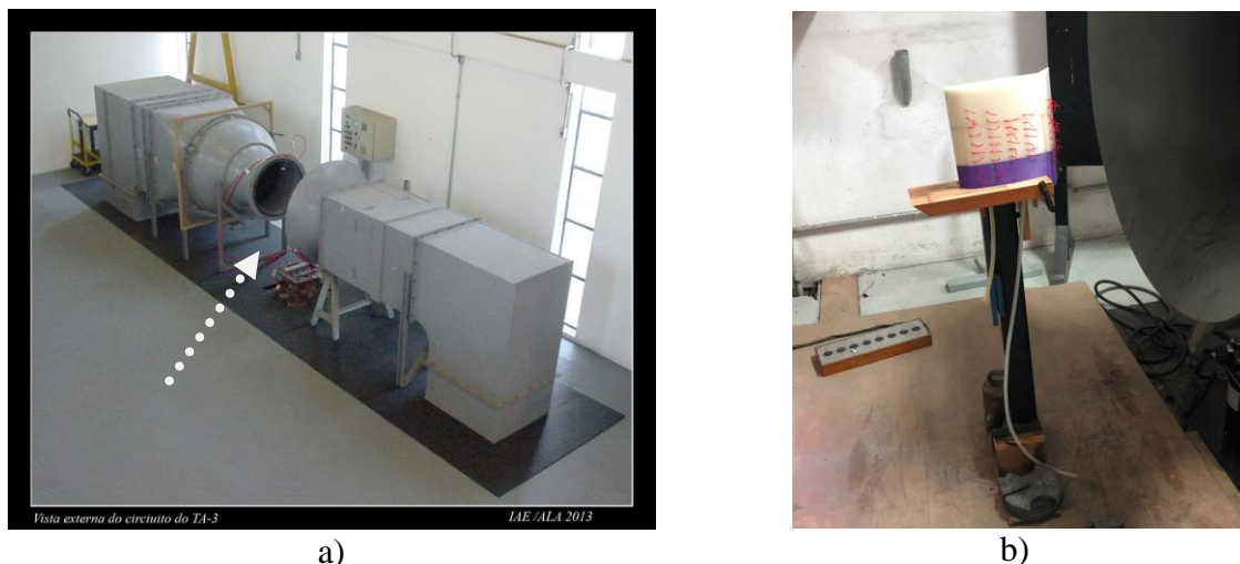
Figura 1. a) Vista externa do circuito aerodinâmico TA-3. A seta indica a seção de ensaios. b) Modelo posicionado no centro da seção de ensaios.
