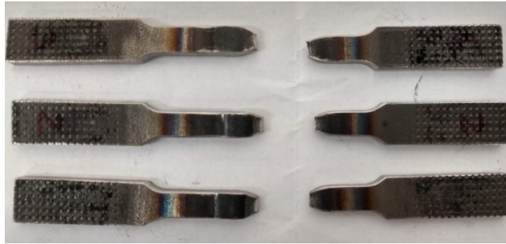
Figura 11 – Corpos de prova “com reforço” após o ensaio de tração.
