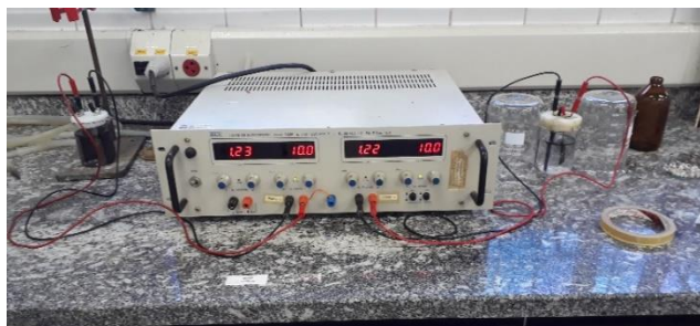
Figura 1: Esfoliação eletroquímica do grafite.
