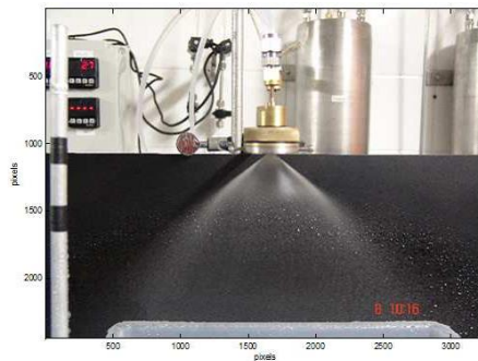
Figura 2: Avaliação experimental de um injetor de combustível, Vásquez [4].
