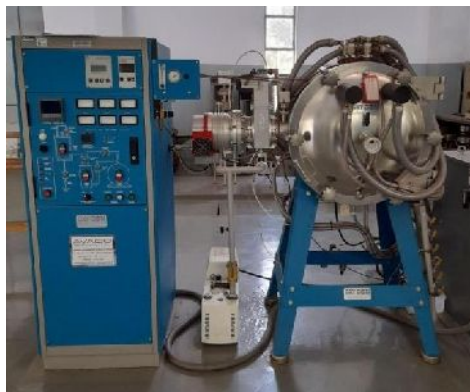
Figura 2 – Forno de alto vácuo para sinterização dos compósitos (AMR/IAE).
