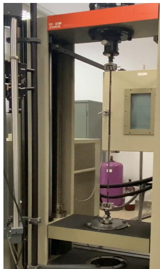
Figura 3 – Corpo de prova no ensaio de T-Peel sem ruptura total no ponto máximo da máquina.
